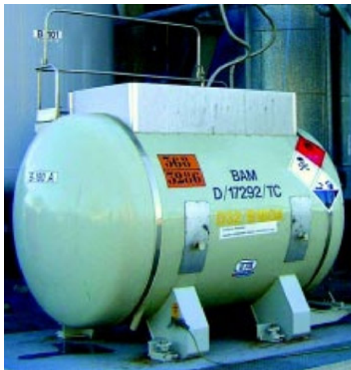
Figura 3 Cisterna móvil con panel y etiquetas de identificación de sustancia peligrosa según ADR.
